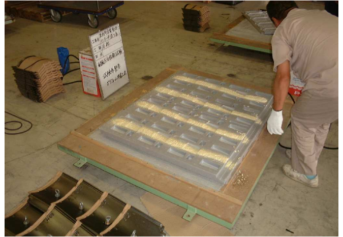
断熱ルーフの裏面にポリフォームを吹き、野地に接着する
