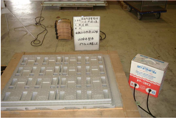
断熱ルーフの裏面にポリフォームを吹き、野地に接着する
