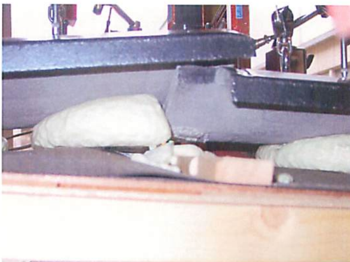
写真-16 破断状況(J型セメント瓦, 標準施工)
