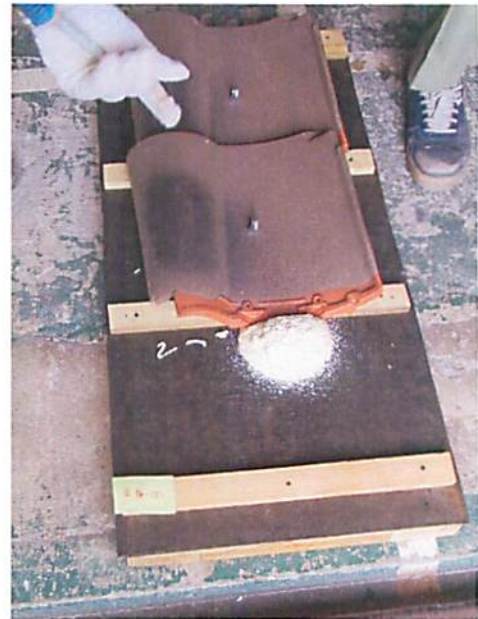
写真-2 S型粘土瓦標準施工状況
