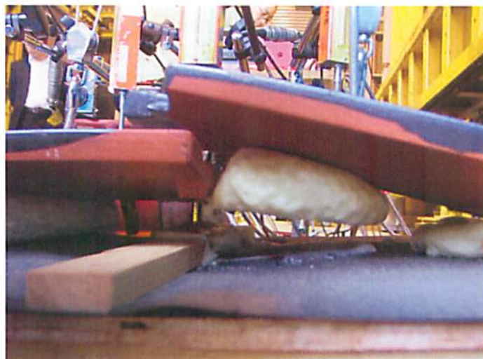
写真-11 破断状況(J型粘土瓦, No.2, 標準施工)
